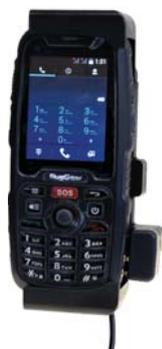
Chargeur véhicule 12 volts et 24 volts, prise allume cigare. Chargeur pour RG310 / IPP'Alert. Note : Les détecteurs de perte de verticalité et d'immobilité sont automatiquement désactivés lorsque le téléphone se trouve sur le chargeur.
